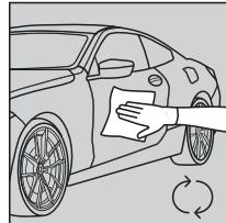
**2** Następnie przetrzyj kolistymi ruchami odłuszczaną powierzchnię drugą czystą mikrofibą w celu dotarcia preparatu i upewnienia się, że wszystkie zanieczyszczenia zostały usunięte.
